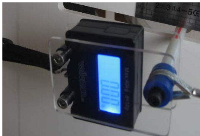
Capteur d'effort avec le repère de mesure de déplacement
