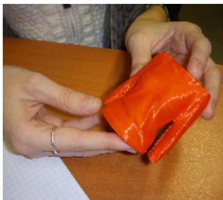
Découvrir une réalisation par un procédé de prototypage rapide : une imprimante 3D par dépôt de fil en fusion basée sur une architecture de robot DELTA.
