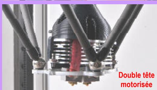
Le ROBOT-PRINTO 3D® est un outil pour le prototypage rapide. L'élève conçoit une pièce par exemple avec un logiciel de CAO 3D type SolidWorks®, sauvegarde la pièce au format STL. La pièce est ensuite tranchée avec le logiciel KISSLICER® et enregistrée au format Gcode. L'élève branche le ROBOT-PRINTO 3D® à l'ordinateur via le port USB et importe le fichier Gcode dans l'interface de pilotage REPETIER-HOST® puis lance l'impression.
