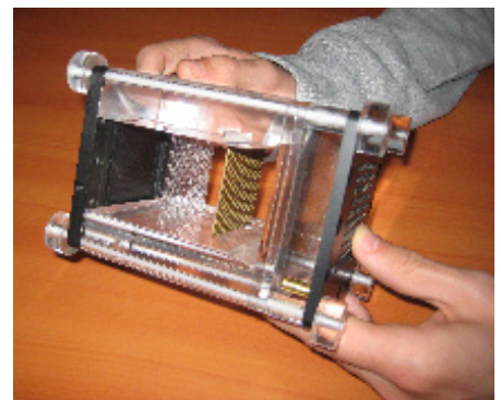
Pile en éclaté
